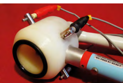
Prototyp zmodyfikowanej głowicy do elektrofonoforezy (P120758) oraz głowicy do fonofotomagnetoforesy (PL 215197)
